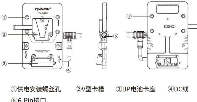
①供电安装螺丝孔    ②V型卡槽    ③BP电池卡座    ④DC线
